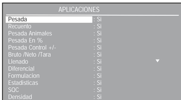
Al presionar el botón **de entrada** mediante los botones de flechas, cada punto de la pantalla de modalidades de aplicación se puede encender o apagar. Al terminar, presione el botón **del menú** y la balanza vuelve a la modalidad de pesar. Todos los ajustes se guardan.
