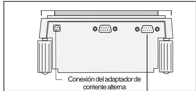
Conexión del adaptador de corriente alterna
