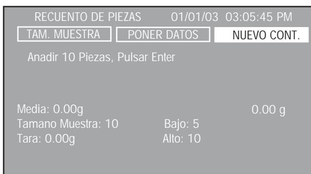
La balanza indica que se agreguen 10 piezas y tiene un valor inferior a 5 y un valor superior a 10, ajustados como valores predeterminados, y el peso promedio por pieza no ha sido ajustado. Coloque 10 piezas sobre la plataforma y presione el botón **de entrada**.
