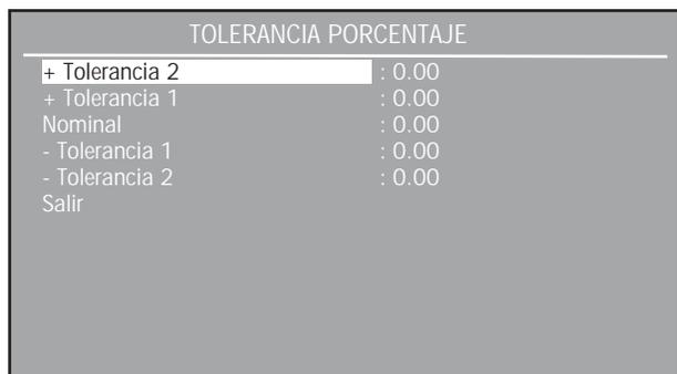
Una vez escogidas todas las opciones, salir del menú de AJUSTAR CCE. Al presionar el botón **de Entrada** se dará inicio a la aplicación de CCE. Continuar colocando muestras sobre la bandeja hasta que se hayan introducido los valores de todas las muestras. Las siguientes son pantallas de ejemplo para 5 grupos. Un peso nominal de 50.00 g. con T1 ajustado a 5 g. por encima y por debajo, y T2 ajustado a 10 g. por encima y por debajo. Se muestra un historial de muestras de 5 grupos.
