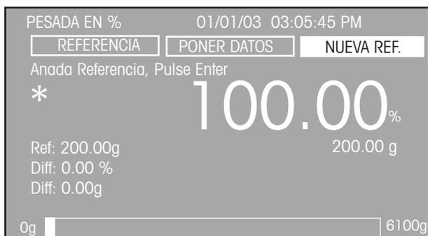
Se retira el peso de referencia y se coloca un segundo peso sobre la plataforma. El ejemplo ilustra un peso de 50g.
