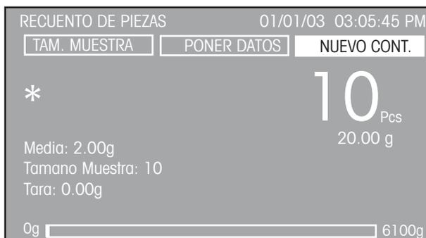
Coloque las partes que se van a contar sobre la plataforma. La balanza muestra el número de piezas.
