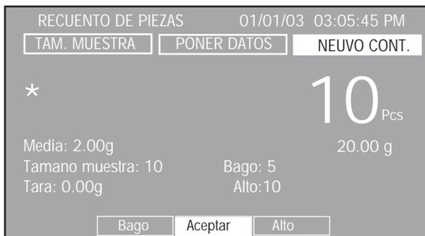
Se ha ajustado el peso promedio por pieza al colocar las piezas sobre la plataforma. Para usar la revisión de piezas, los valores superior e inferior se deben haber ajustado así como otros parámetros de ajuste de lectura. Revise los ajustes y determine los parámetros de la balanza para ajustarlos a requerimientos específicos.
