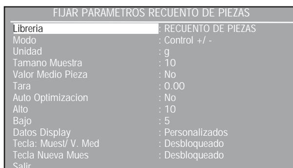
Se han añadido dos entradas adicionales al AJUSTE DEL CONTEO DE PARTES: los valores superior e inferior. Consulte la sección de ajustes con respecto a conteo de partes, para una descripción de todos los demás ajustes.
