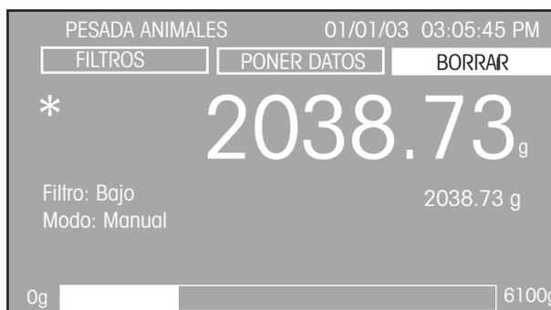
Retire el animal de la plataforma. Con la tecla BORRAR resaltada, presione el botón **de entrada** para borrar el peso. La balanza queda lista para otra medida. Para cambiar la modalidad de operación de manual a semiautomática o automática, y para cambiar los niveles de filtro, consulte la sección de ajustes.
