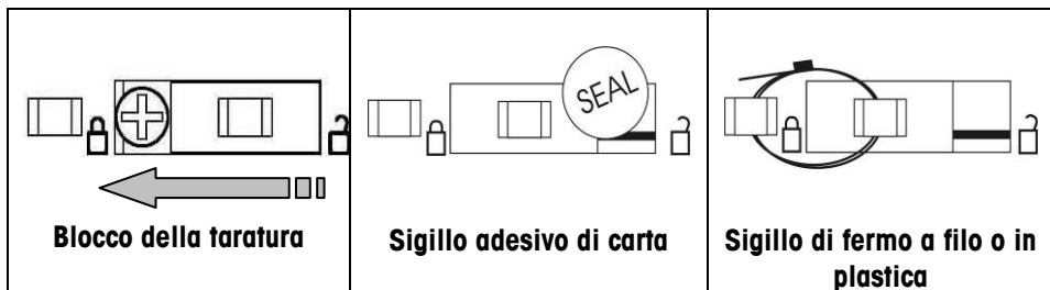
Figura 4-1. Blocco e sigillo dell'interruttore di blocco della taratura
