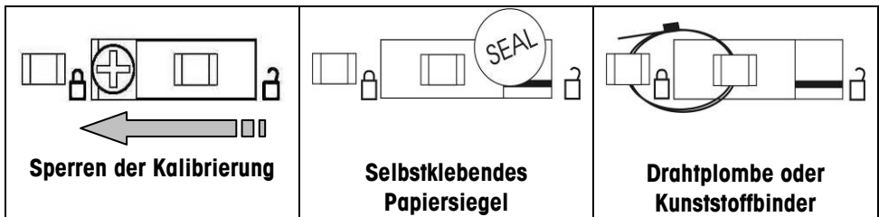
Abbildung 4-1. Sperren und Versiegeln des Kalibrierungssperrschalters
