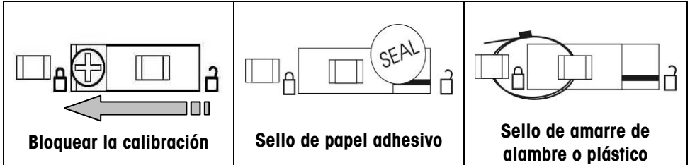
Figura 4-1. Bloqueo y sellado del interruptor del seguro de calibración
