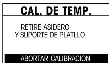
**Nota:** La unidad **no podrá efectuar la calibración** si no se ha retirado el soporte del platillo.
