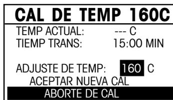
Este ajuste se efectúa con dos lecturas (100 °C y 160 °C). El desecador empezará a calentarse ahora hasta alcanzar la segunda temperatura (160 °C). El ajuste de la temperatura se define mediante dos medidas. Proceda igual que para la primera temperatura. Cuando haya definido la pantalla de acuerdo con el termómetro, seleccione de nuevo ACEPTAR NUEVA CAL y pulse el botón **Enter**. La pantalla volverá a mostrar el menú CONFIG. ANALIZDOR.
