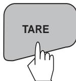
Pulse el botón **Tare**. Esto permite poner a cero el analizador de humedad. Aparecerá una nueva pantalla con instrucciones
