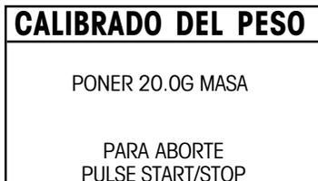
Coloque el peso requerido en el platillo de muestras y cierre la tapa.
