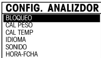
Pulse el botón **Setup**. Use los botones de flecha para seleccionar BLOQUEO y pulse **Enter**.
