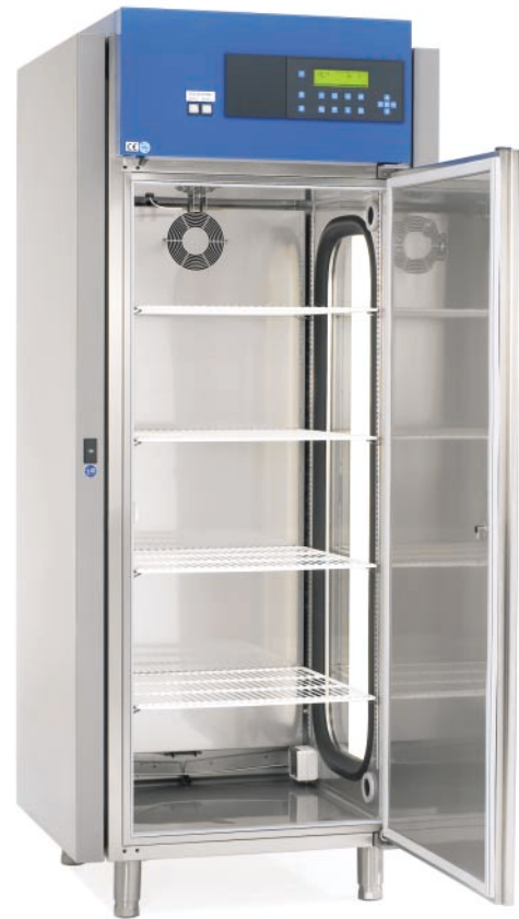
1301 mit Optionen Temperaturbereich -20 bis +50°C Prüfraumgröße 530 Liter Beleuchtung von beiden Seiten
