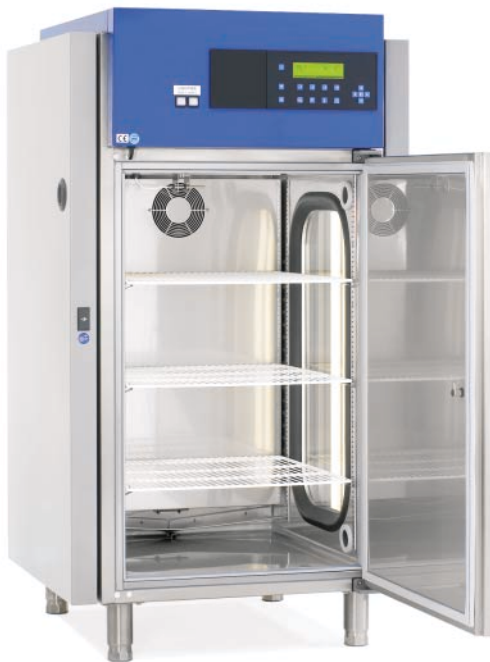
1201 mit Optionen Temperaturbereich -20 bis +50°C Prüfraumgröße 350 Liter Beleuchtung von beiden Seiten
